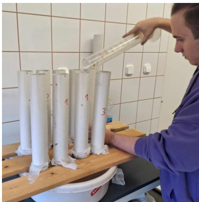
2. ábra: Az olaj és víz keverékét tartalmazó folyadék átengedése a gyapjún
