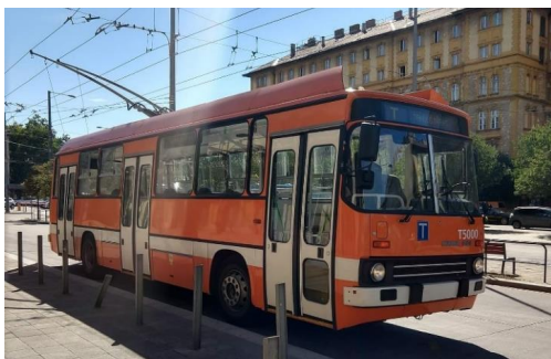
Ikarus 263 típusú autóbusból átalakított trolibusz Budapesten, 2022 júliusában. Ez csupán kísérleti jármű, a BKV állományában tanulójáratként teljesít azóta is szolgáltatást (saját fotó)
